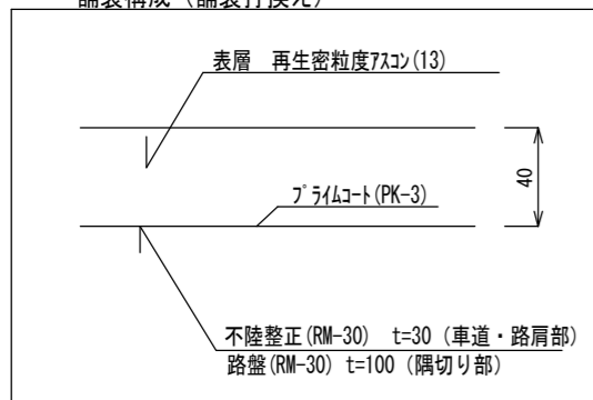
舗装構成 (舗装打換え)
