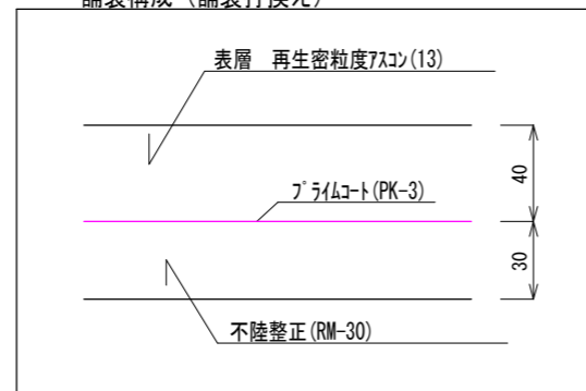
舗装構成 (舗装打換え)
