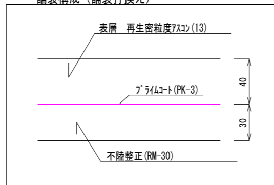
舗装構成 (舗装打換え)
