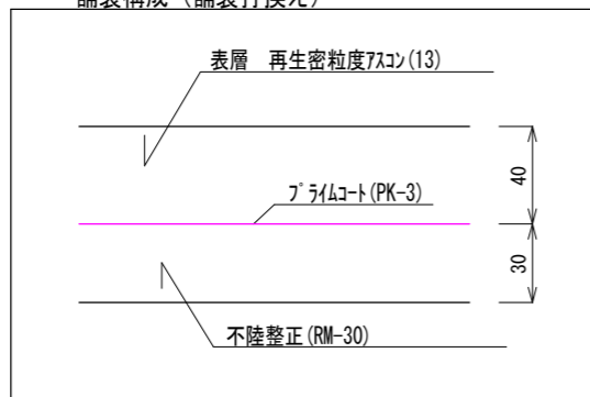
舗装構成 (舗装打換え)
