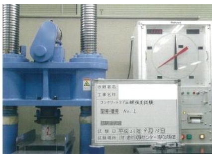
圧縮強度試験状況
