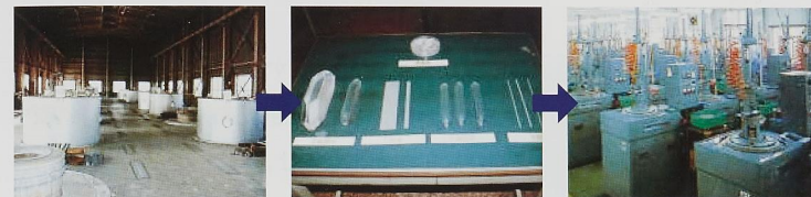
原料をいったん溶かして人工水晶を作る
