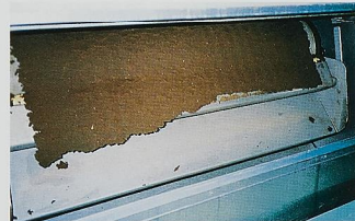
脱水機によってしぼられた汚泥(脱水ケーキ)
