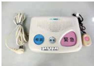
緊急通報装置
