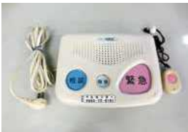
緊急通報装置
