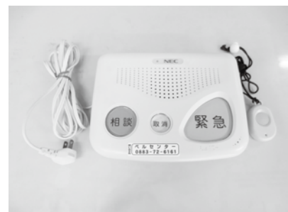
緊急通報装置
