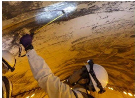
点検ハンマーによる打音検査
