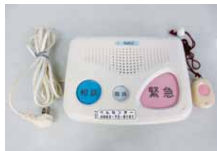
緊急通報装置
