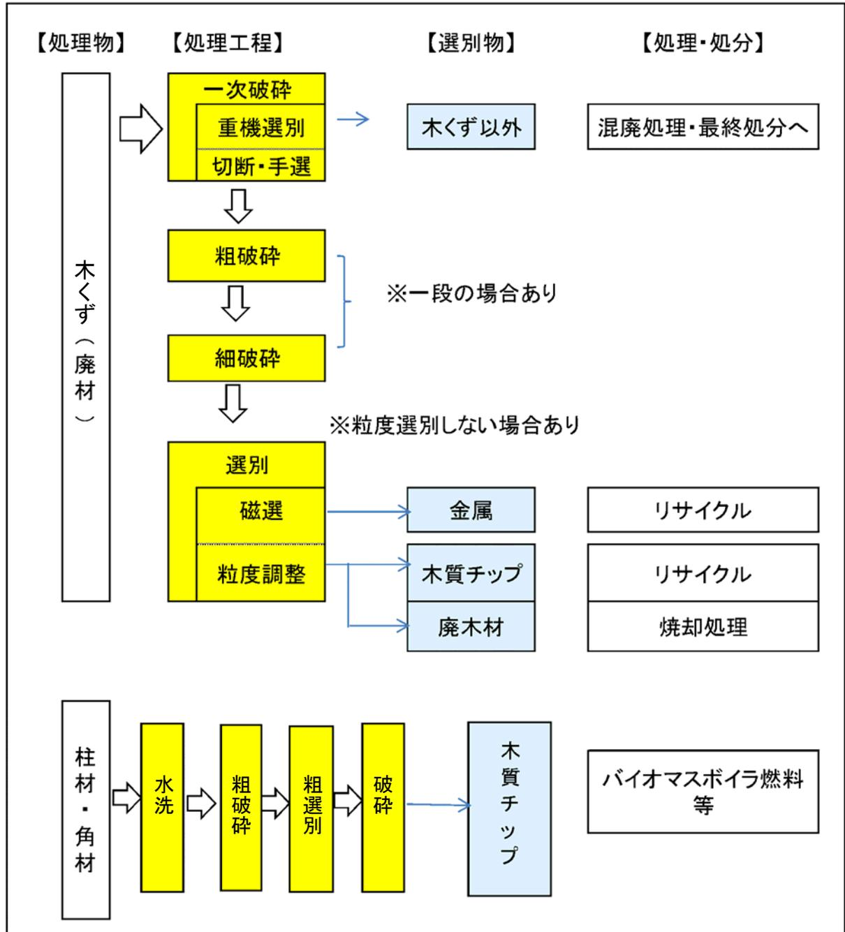
図 2- 9 木くずの処理フロー
