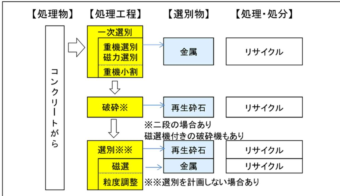
図 2-8 コンクリートがらの処理フロー
