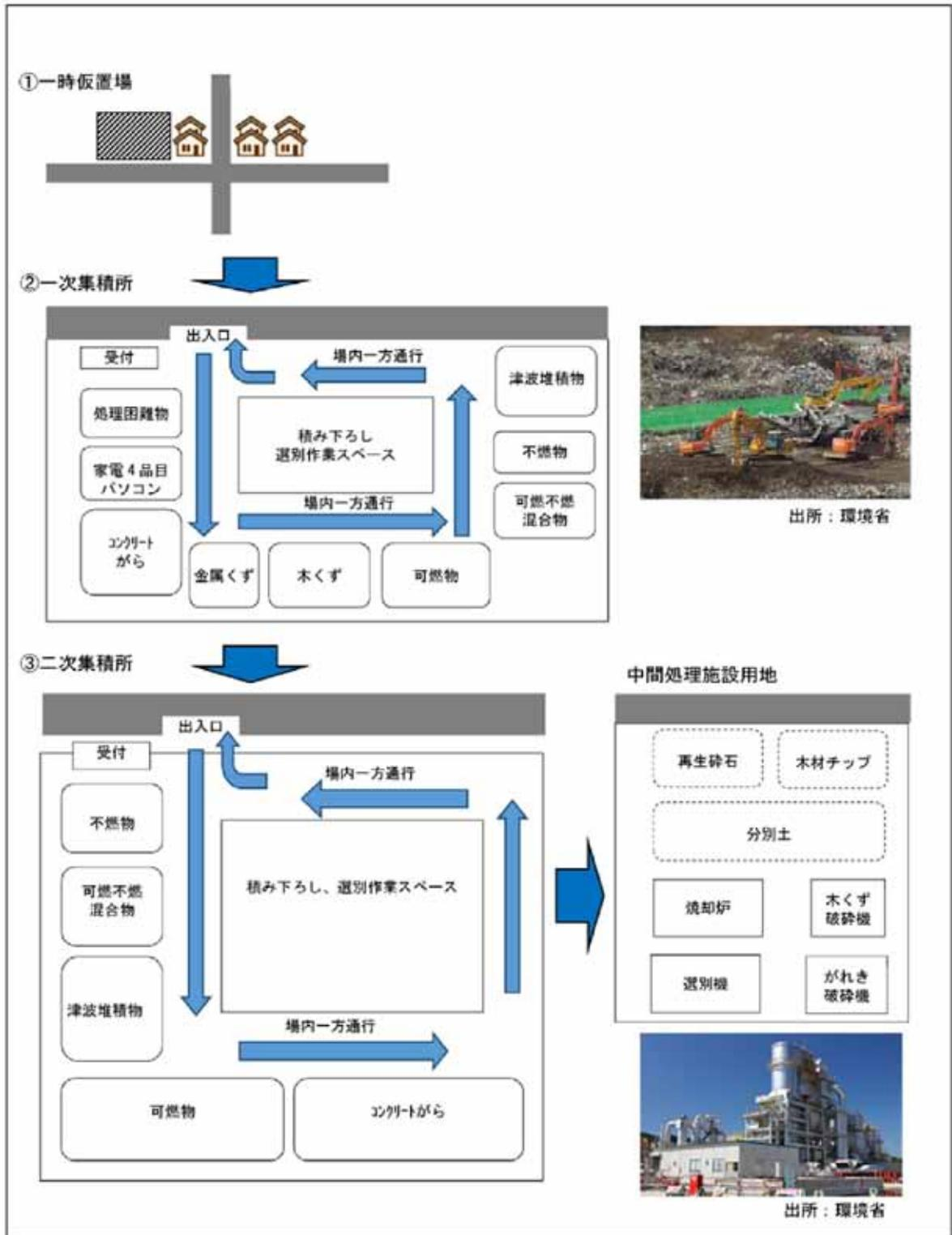
図2-12 仮置場処理フローとレイアウト例
