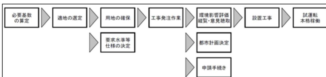
図2-16 仮設焼却炉等の設置までの手続き
