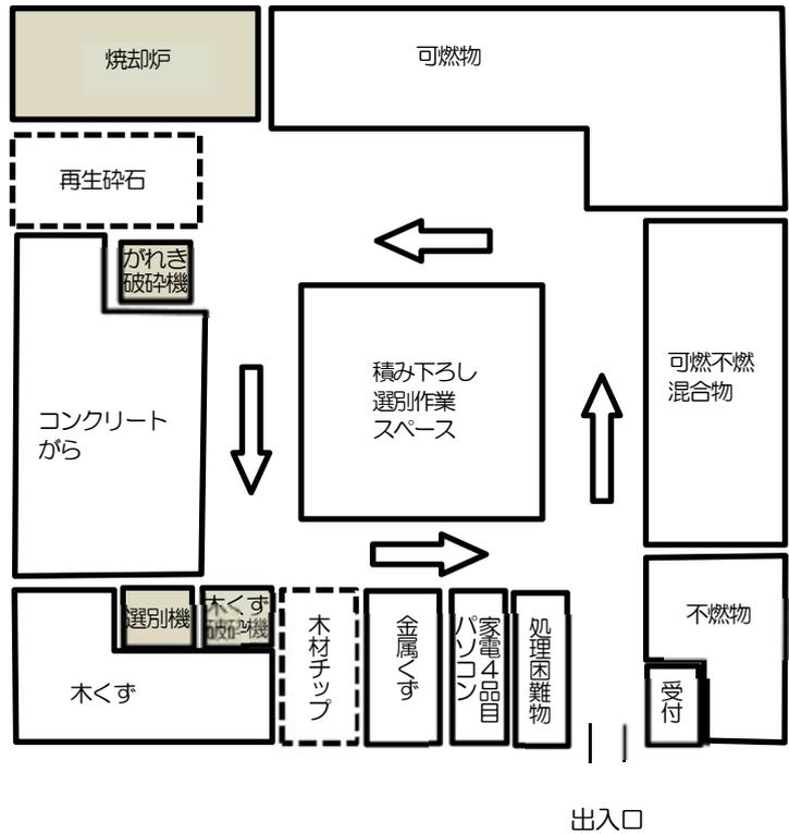
図 2-14 中間処理施設他を含む集積所のレイアウトの例
