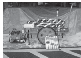
可搬式消防ポンプ一式
